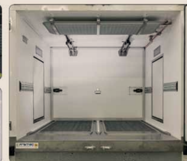
FRESH TEMPERATURE THROUGH EUTECTIC PLATES Frische Temperatur mit eutektischen Platten
